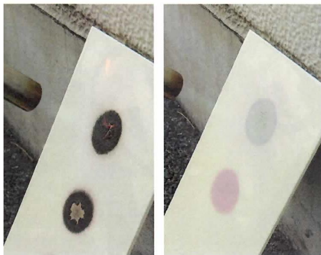
ガスバーナーによる塗膜の燃焼性比較
